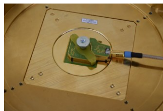
Bild 10 Arretierung des EFM 04 nach rechts drehen
