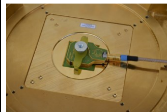
Bild 11 Rändelschraube des EFM 04 leicht festziehen
